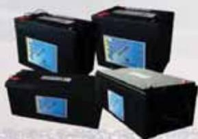
Les Batteries Technologie AGM HAZE / ATMB, offrent de nombreux avantages comparativement aux batteries au plomb classiques. De part leurs conceptions au plomb calcium étain avec plaques épaisses, elles sont étanches et totalement sans entretien. Ces batteries ont un faibles taux d'auto décharge, les gaz émis en fonctionnement sont recombinés à 99%, ce qui les rends particulièrement indiquées pour les bateaux. Les bacs sont réalisés en ABS résistant aux chocs.
